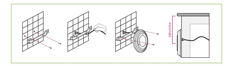
IMPORTANTE: Se recomienda no empalmar el cable bajo el agua o bajo tierra, dado que es posible que ingrese agua a través de las vainas interiores y por allí a la luminaria. Si es inevitable, utilizar spaghetti termocontraible o cinta autovulcanizable, especial para uso sumergible.
